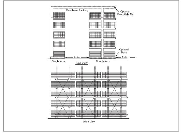
Fig. A-11. Cantilever rack
